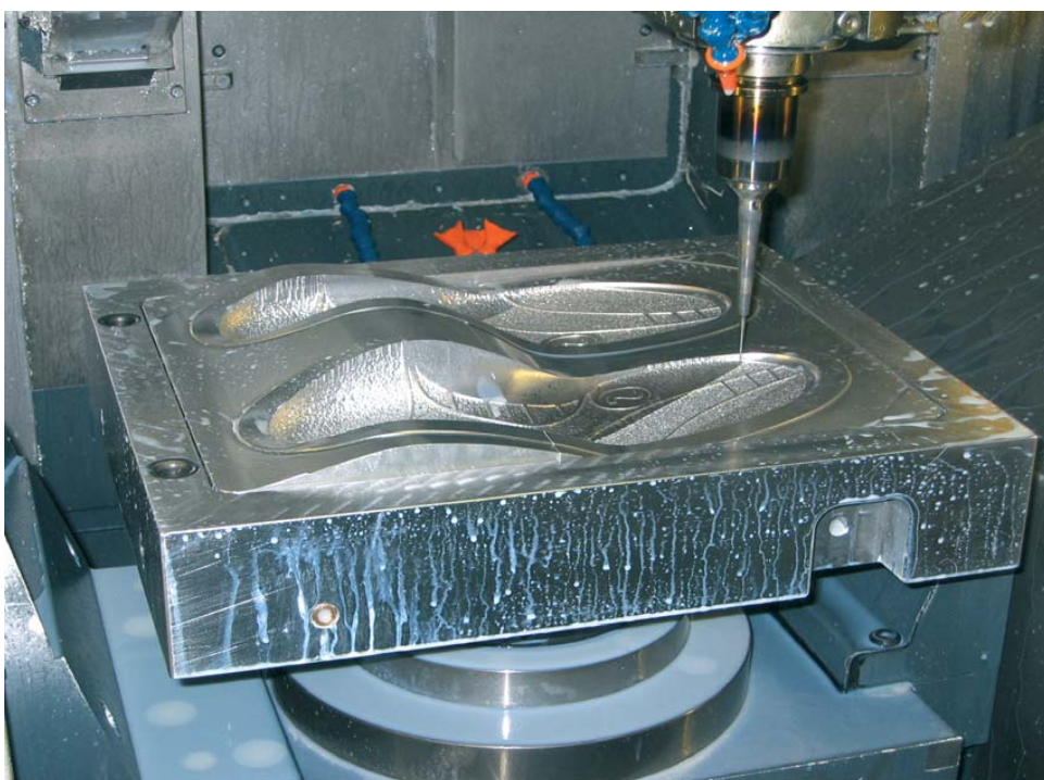
Die NC-Programme zum Schlichten können aufgrund der 3D-Sohlen-Texturen relativ umfangreich werden und stellen hohe Anforderungen an die SCHOTT-Software.
