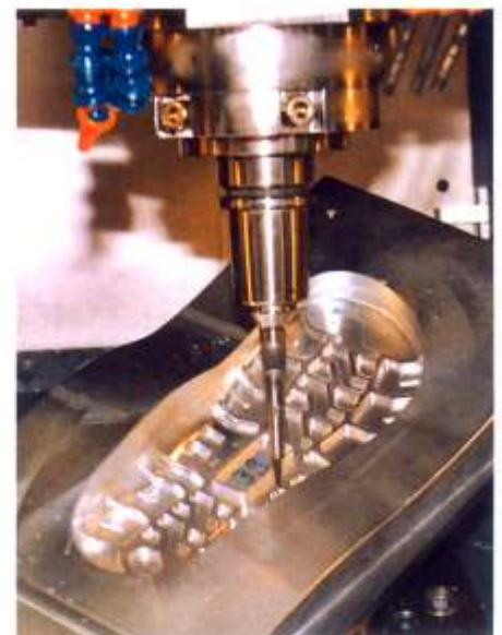
Hochfester Aluminiumblock bekommt Profil – fünf Achsen und ein Dreh-Kipptisch lassen nun auch Hinterschnidungen zu.
