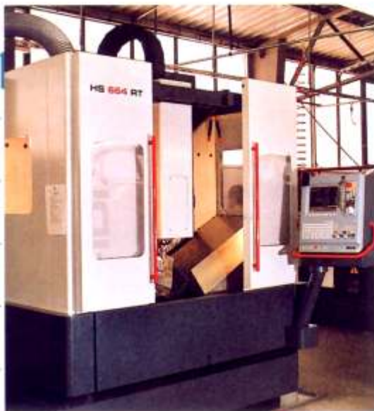
Momentan noch Unikat: Die HS 664 RT bei Alsa verfügt über eine Emulsions-Nebelabsaugung, die Fidia hier im Praxiseinsatz testet.
