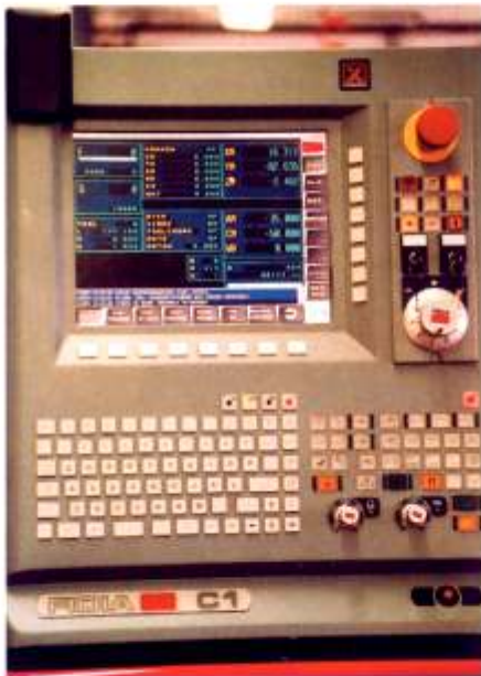
Die Steuerung erhält ihre Daten direkt aus dem CAD/CAM-System.
